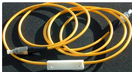
Figura 2 – Sensor de temperatura óptico em FBG ( Fiber Bragg Grating )
