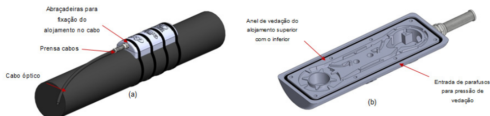
Figura 3 – Ilustração do protótipo final do dispositivo de acoplamento do sensor FGB
