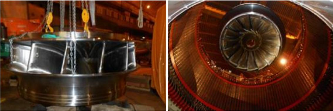
Figura 9 - Novo rotor Francis da Usina Hidrelétrica de Ponte de Pedra
