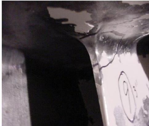
Figura 1 - Trincas que ocorreram em projeto semelhante
