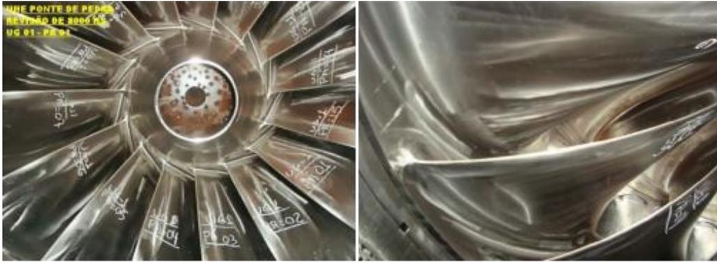
Figura 12 - Rotor da unidade 1 da Usina Hidrelétrica de Ponte de Pedra durante a inspeção de 8000 h [2]
