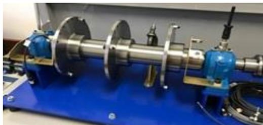
Figura 4 – Bancada para análise de vibrações com simulação de defeitos PECCE – IFSC.
