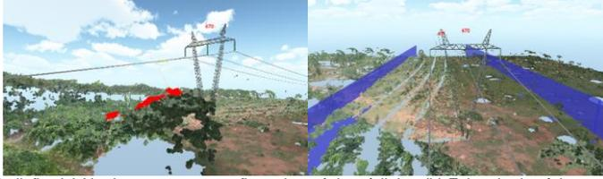
FIGURA 5 – Medição: (a) No destaque, vegetação muito próxima à linha. (b) Faixa de domínio representada como muro virtual
