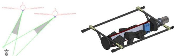
FIGURA 1 – (a) Ação do Gimbal Ativo acompanhando o eixo das Torres. (b) Imagem representativa do equipamento
