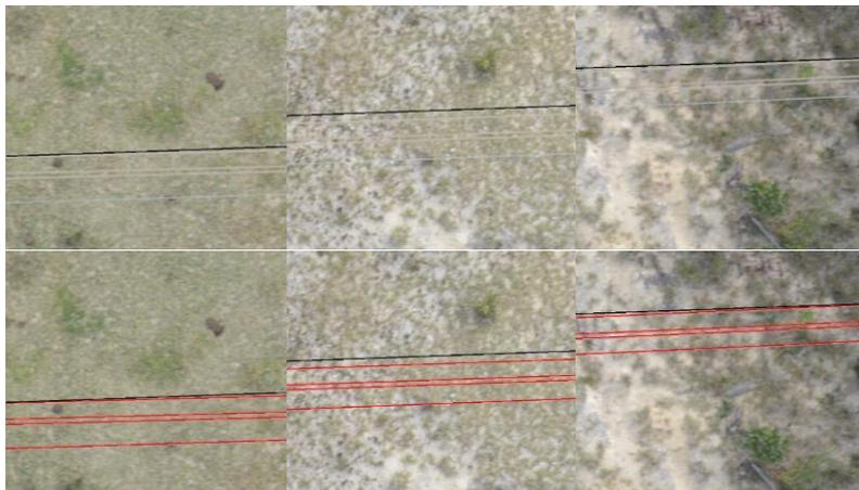
FIGURA 3 – Detecção de fios: A linha em preto é a reta entre os extremos do cabo de cima, inserida para referência. Em vermelho, os fios detectados (3 condutores e um para raio). Destaque para a robustez do método.
