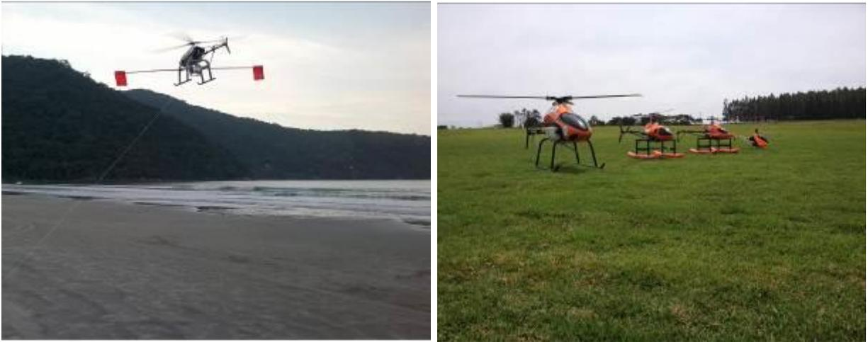
Figura 5 - Primeiros aeromodelos utilizados para lançamento de cabos pilotos
