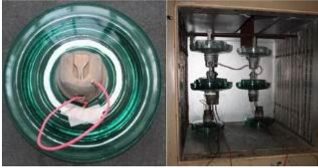
FIGURA 3 - Ensaio de medição do dielétrico
