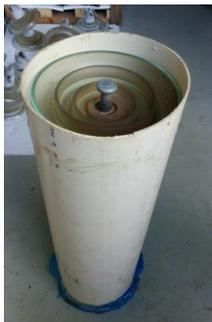
(c) Isoladores de vidro tipo disco colocados dentro de tubos de PVC
