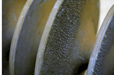
FIGURA 7 - Distribuição das gotas na superfície de um isolador polimérico
