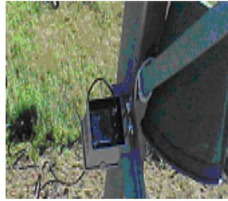
Foto 2 - medição corrente fuga
