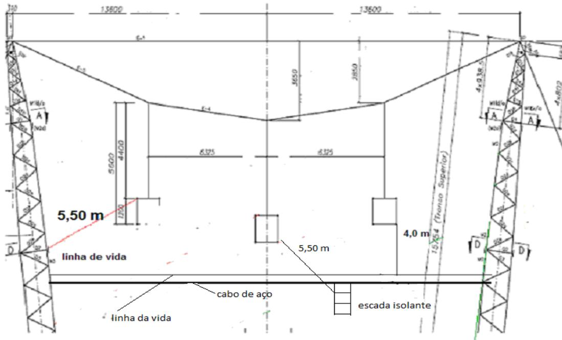
Figura 8- esquema de lavagem em torre "cross rope"
