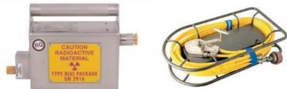
FIGURA 16 - Equipamento de radiografia digital portátil com raios gama
