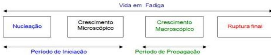
Figura 1 – Representação gráfica dos estágios do processo de fadiga (2).
