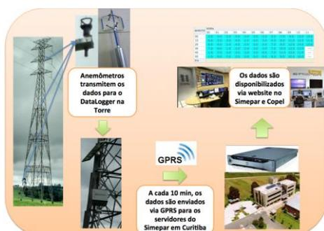
FIGURA 2 – Ilustração do sistema de coleta e transmissão de dados
