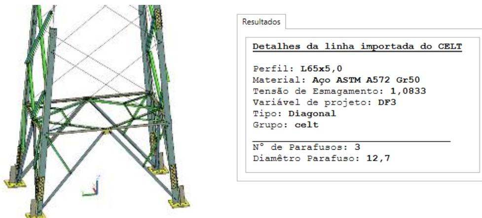
FIGURA 7 – Lançamento das peças na modelagem 3D e informações importadas do cálculo
