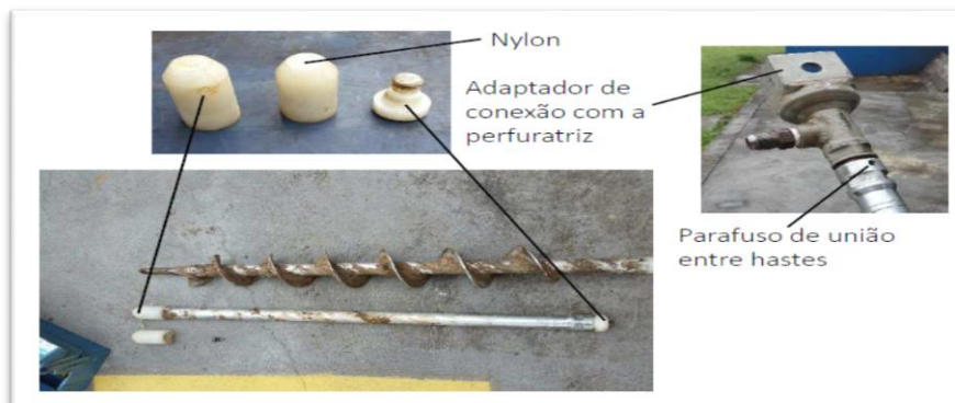
FIGURA 2 – Detalhes construtivos do trado
