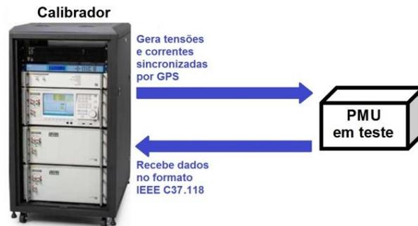
FIGURA 3 – Calibrador de PMUs
