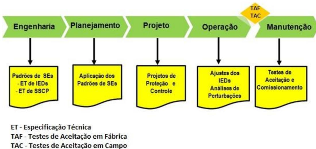
FIGURA 1 - Atividades referentes à Proteção, Controle e Automação em cada Processo
