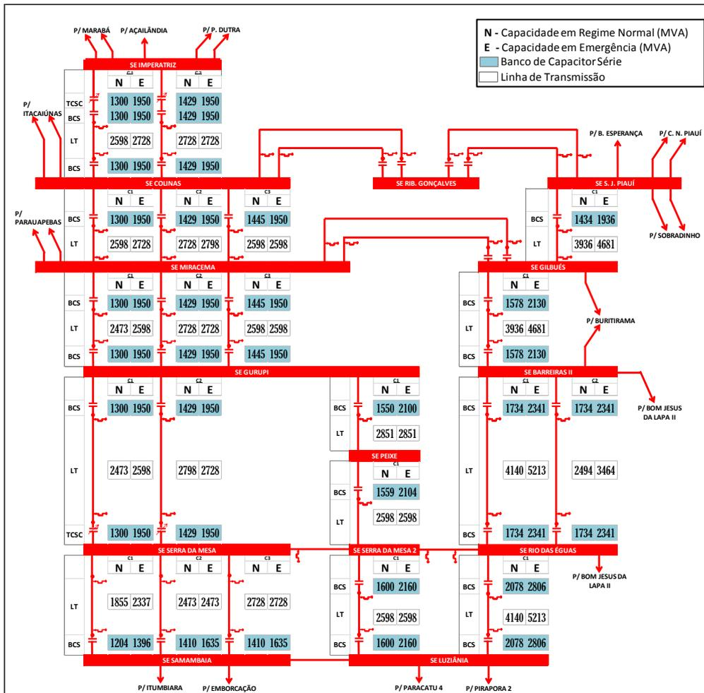
FIGURA 1 – Capacidade em Regime Normal e em Emergência de LTs e Respetivos BCS
