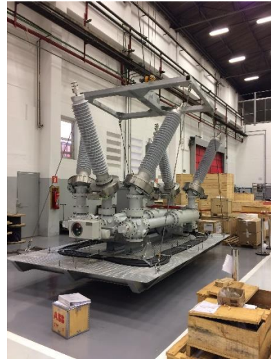
Fig. 8: Detalhe do içamento, mostrando a cruzeta dedicada e seus cabos, com o módulo compacto sendo suspenso
