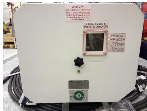
Fig. 12: Acionamento do disjuntor, com detalhe da janela de indicação de carga da mola
