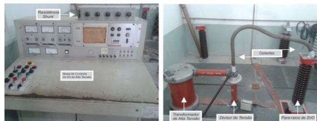
FIGURA 11 - (b) – Fotografia do Arranjo Experimental
