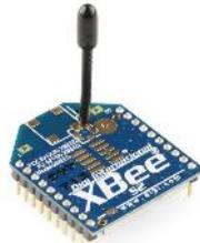
FIGURA 6 - Módulo de Comunicação Xbee-pro Baseado na Tecnologia ZigBee.
