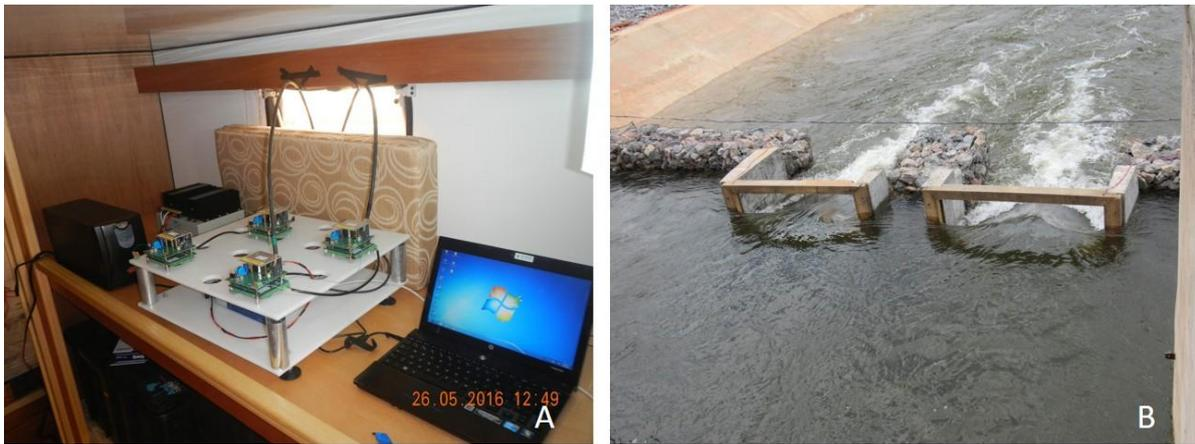
FIGURA 3 – (a) Sistema *Multireader* instalado em uma das salas de controle. (b) Sistema de antenas para detecção por rádio frequência instalado no STP.
