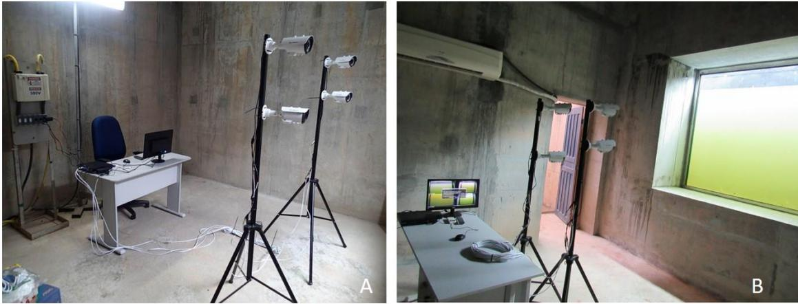
FIGURA 5 – (a) Equipamentos de monitoramento de vídeo-imagem instalados em uma das salas de observação. (b) Posição das câmeras de monitoramento em relação a janela de observação do STP.
