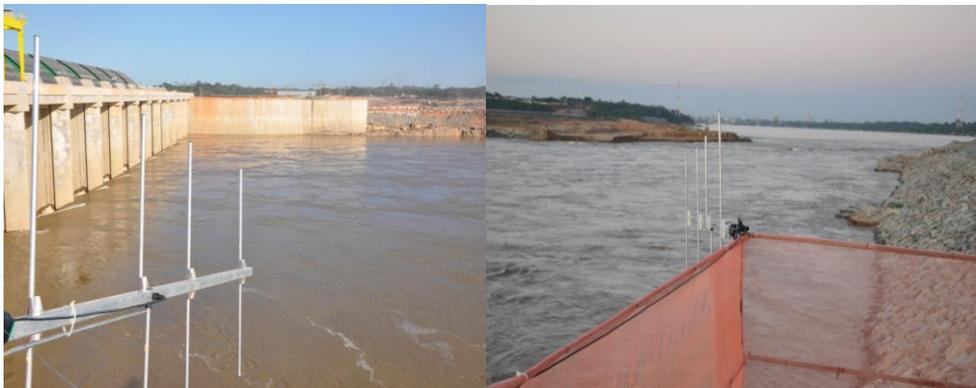
FIGURA 4 – Antenas de radiotelemetria para detecção de peixes a montante e a jusante do VTP da UHE Santo Antônio.
