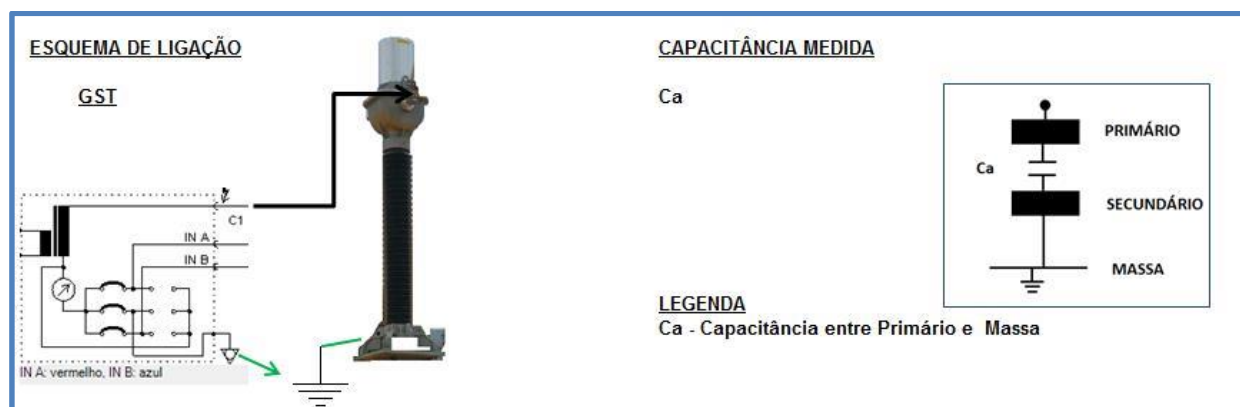
FIGURA 1 – ESQUEMA DE LIGAÇÃO DE ENSAIOS DE ISOLAÇÃO PARA TC
