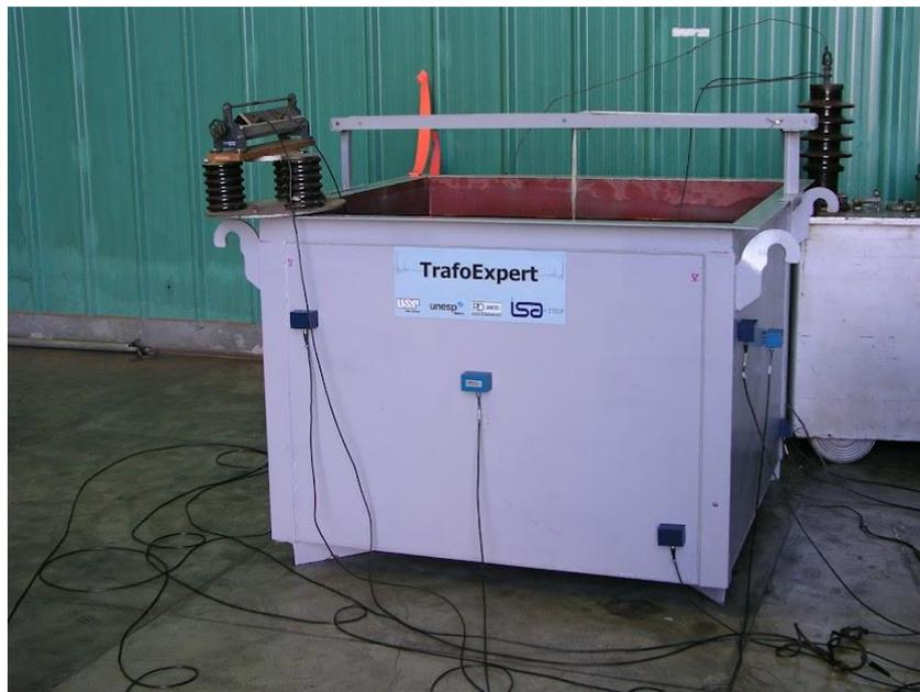
Figura 2 – Disposição dos sensores de emissão acústica fixados ao lado de fora do tanque experimental repleto com óleo isolante.
