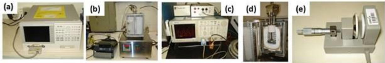
FIGURA 1 – Equipamentos de instrumentação (a) impedâncímetro, (b) forno de caracterização eletrotécnica com registrador automático de dados, (c) Osciloscópio e eletrômetro e porta-amostras, (d) porta amostra para medições com controle de temperatura e (e) porta amostra para medições em camada fina utilizados na caracterização elétrica dos compósitos estudados.
