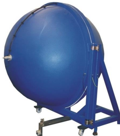
FIGURA 1 – Esfera integradora utilizada para os ensaios fotométricos
