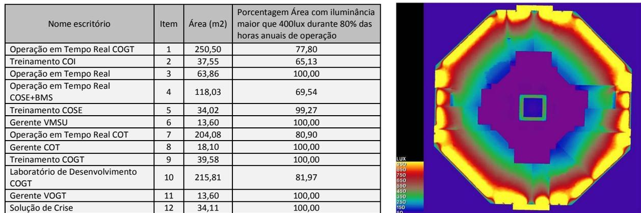
FIGURA 4 – Simulação do nível de iluminância do 4º pavimento dos Centros de Operação. Vidro Neutral 70
