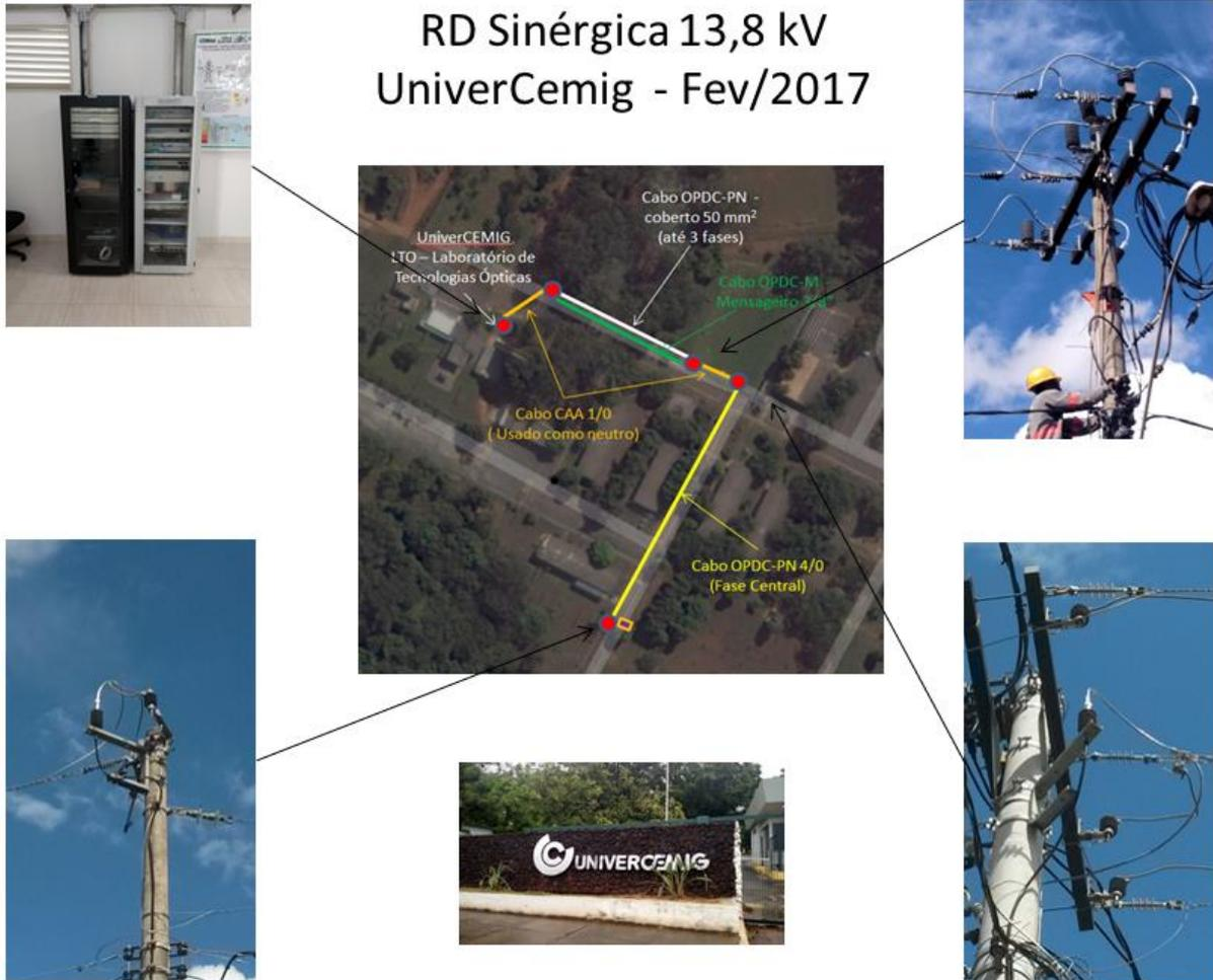
Figura 2. Visão da planta piloto da rede sinérgica de distribuição na UniverCemig.
