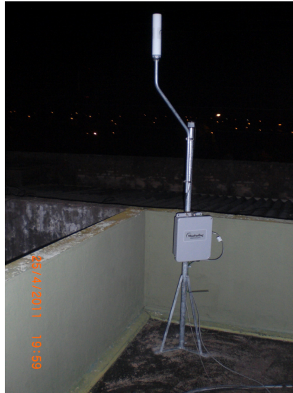
FIGURA 3 – Sensor para a detecção de descargas atmosféricas da rede BrasilDAT.
