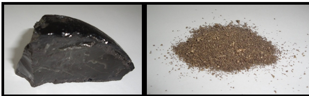
Figura 4: Agregado Li-Al uso na indústria de cimento e cerâmica (esq) e liga Cu-Co-Fe-Ni para refino e reuso na fabricação de baterias lítio-íon (dir) Fotos: Alexandre Pinhel Soares - Tamanho real
