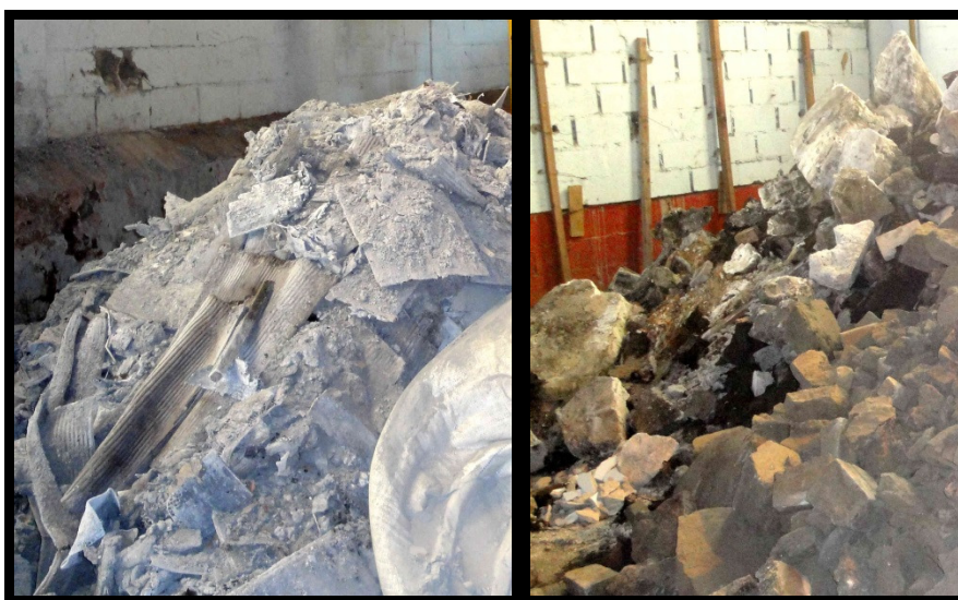
Figura 3: Chumbo secundário (esq) e escória gerada no processo de reciclagem (dir) Fotos: Alexandre Pinhel Soares
