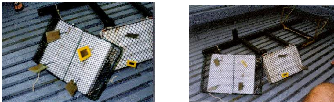
Figura 12- Foto da estrutura de fixação dos corpos-de-prova
