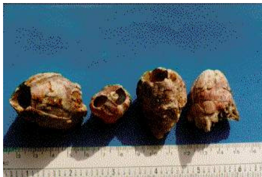
Figura .3 – Exemplo de cracas encontradas no circuito de refrigeração
