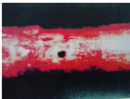
Figura 4 – Craca aderida ao tubo de Cu/Ni 90/10 com diâmetro de 3/4” do trocador do SARET e tubo de cobre com perfuração
