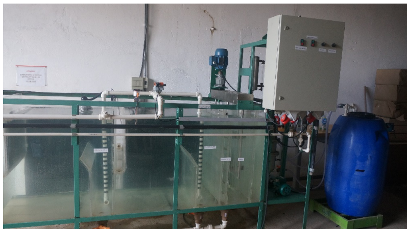
FIGURA 3 – Unidade Piloto de FAD onde Foram Realizados os Testes Experimentais Deste Trabalho
