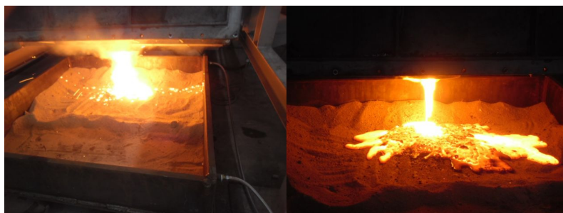
FIGURA 6 - Vazamento do reator
