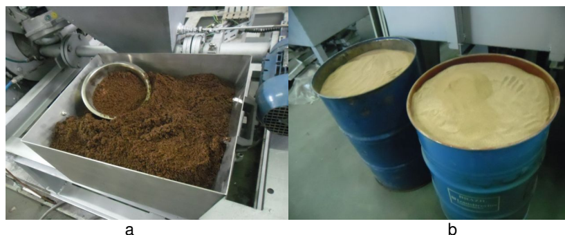
FIGURA 4 – (a) Bauxita: antes do processamento na câmara rotativa a plasma e (b) Bauxita após processamento na câmara rotativa a plasma
