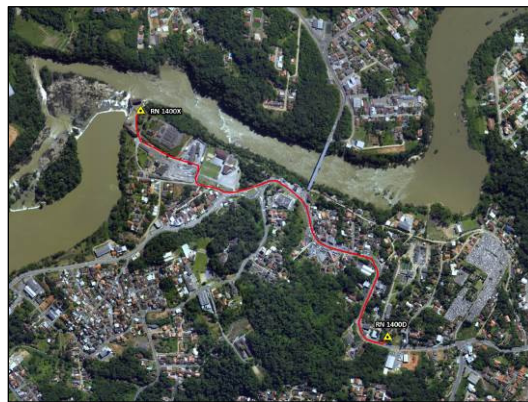
Figura 2 - Trajeto do nivelamento geométrico realizado na Usina Salto, em Blumenau/SC (Fonte: Celesc)
