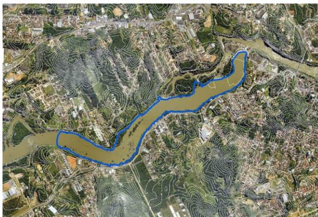
Figura 3 - Levantamento de Cotas e Curvas de Nível através de MDT (Fonte: Celesc)
